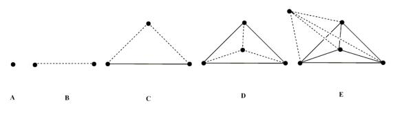
Figure 1.7: n-Simplices of dimension - A) 0D; B) 1D; C) 2D; D) 3D; E) 4D
